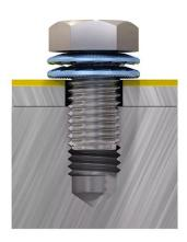
Uniões aparafusadas falham por duas razões – soltura e afrouxamento espontâneos do parafuso. Dessa forma, a tecnologia de travamento por cunha multifuncional da Nord-Lock resolve ambos.
