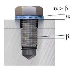
A tecnologia de travamento por cunha da Nord-Lock fixa uniões aparafusas com tensão, ao invés de fricção. O sistema é composto por um para de arruelas de travamento com cames em um lado e dentes radiais no outro.
